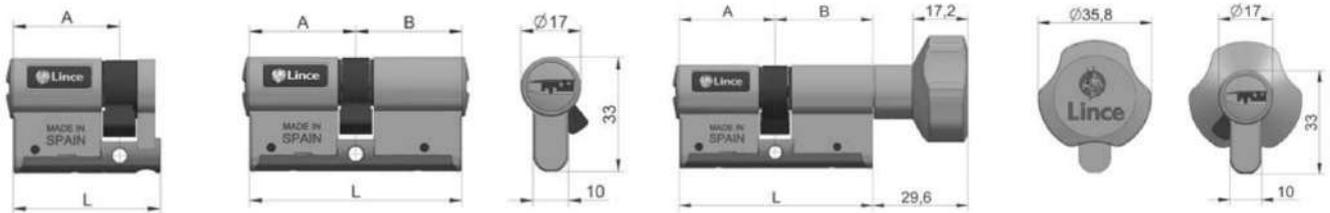
**Cilindro con botón** *Knob cylinder* Cylindre à bouton
