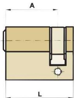
**Cilindro con botón Knob cylinder** Cylindre à bouton
