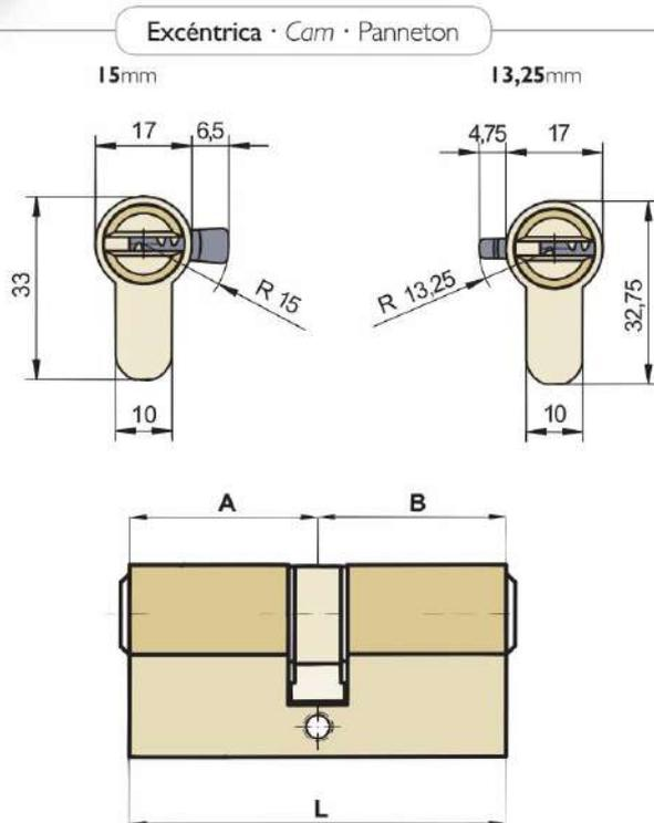
**Cilindro doble Key-key cylinder** Cylindre clef-clef
