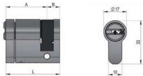
**Cilindro con botón** *Knob cylinder* Cylindre à bouton
