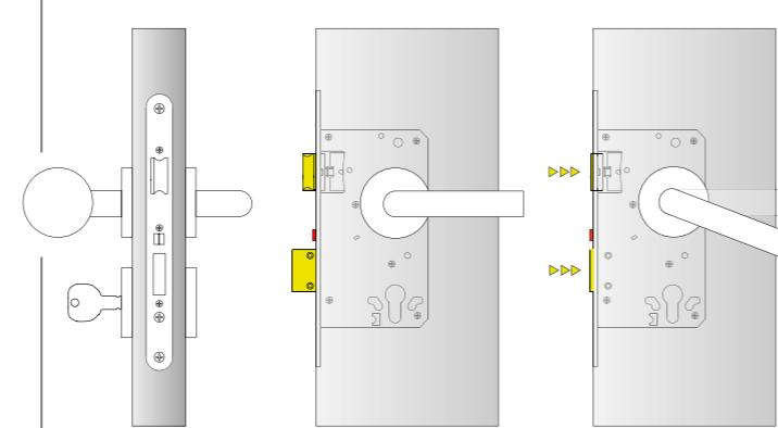
Ao abrir a porta pelo interior com o puxador, ou pelo exterior com o cilindro, recolhe o trinco e a língua e simultâneo /
