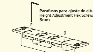
Parafusos para ajuste de altura / Height Adjustment Hex Screws 5mm
