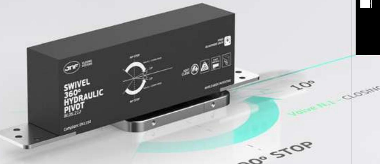
O sistema de Cam combinado com hidráulica permite controlar o fecho de portas pivotantes de grandes dimensões, simultaneamente à sua abertura com pouco esforço. As portas podem ser de abertura simples ou de vai-vem, e com espessura mínima de 50mm.
