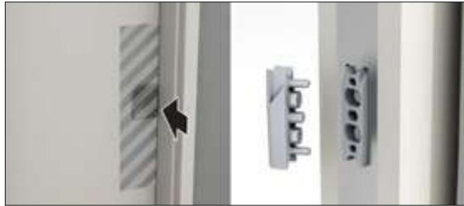
**Em caso de emergência, se não puder remover a puxador da porta na parte interna da dobradiça, abra a porta com força, aplicando uma força séria ao redor da área da alça. Com 1 kN de força, o clipe de segurança na trava irá ceder e a porta se abrirá /**
