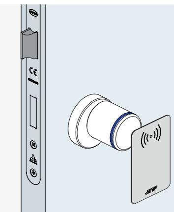
**Aproxima-se um dispositivo MIFARE® autorizado permitindo a abertura da fechadura com a rotação do botão /**
