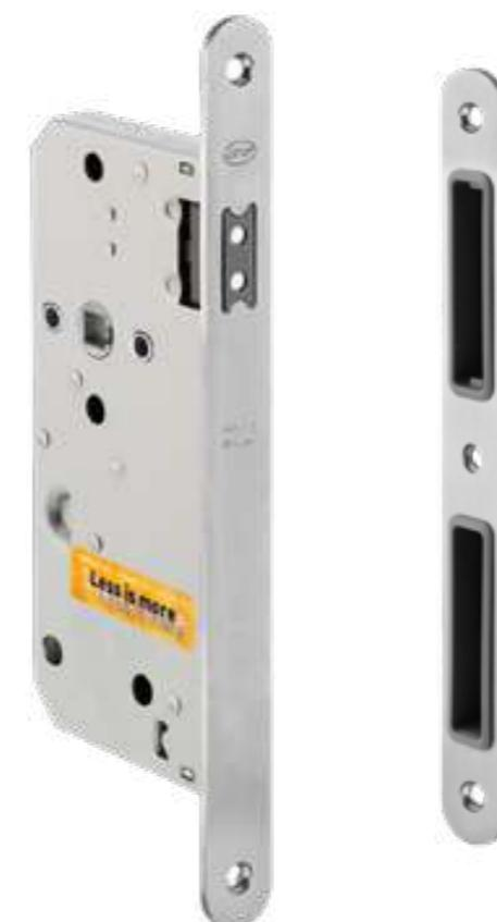
**Chapa testa magnética reversível e ajustável por posição. A folga do trinco em relação à chapa de testa é ajustável em +1mm / -1mm pela rotação de 180° /**
