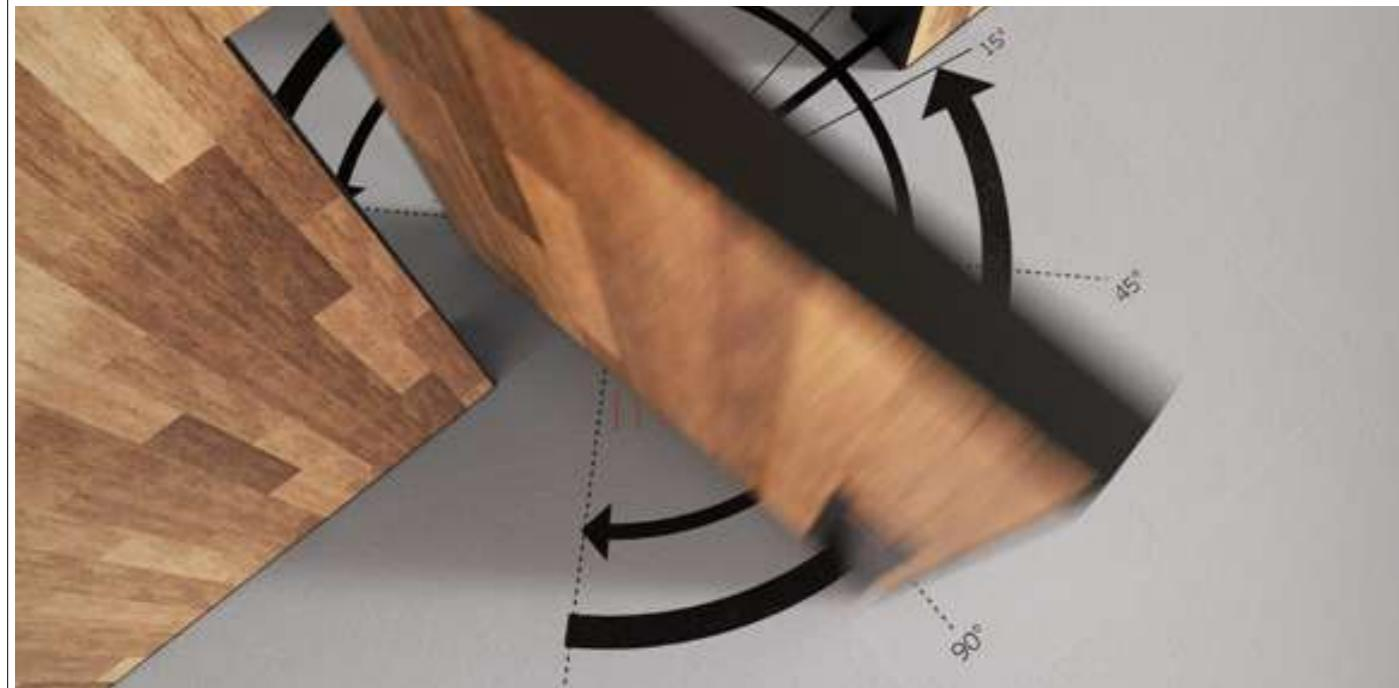
**Sistema pivotante hidráulico para portas até 500kg. As portas podem ser de abertura simples ou de vai-vem, e com espessura desde 60mm. O sistema fica oculto no interior da porta, apenas com uma pequena base no pavimento, com regulação bidireccional e um ponto de rotação no teto ou aro superior da porta com rolamento incorporado.**
