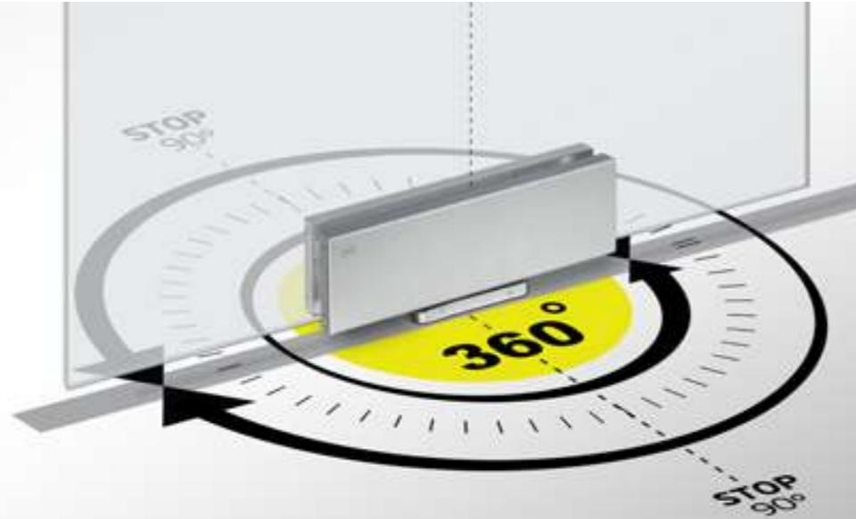
**Sistema pivotante para portas de vidro de grandes dimensões.** O sistema CAM integrado neste pivot permite que a porta possa fazer uma abertura de quase 360°, mantendo o sistema hidráulico com fecho automático e suave. A grande vantagem deste sistema é o facto de poder ser instalado em quase qualquer posição na porta, desde o centro até 5cm do limite seu limite. Permite grandes vãos de abertura assim como peso máximo até 200KG.
