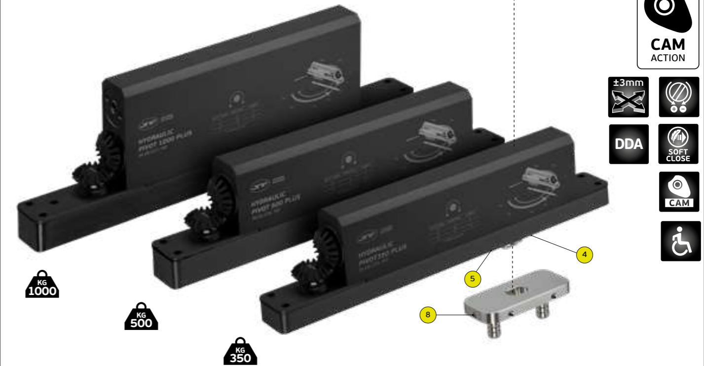
O sistema de Cam combinado com hidráulica permite controlar o fecho de portas pivotantes de grandes dimensões, e simultaneamente a sua abertura com pouco esforço. As portas podem ser de abertura simples ou de vai-vem, e com espessura mínima de 40mm.
