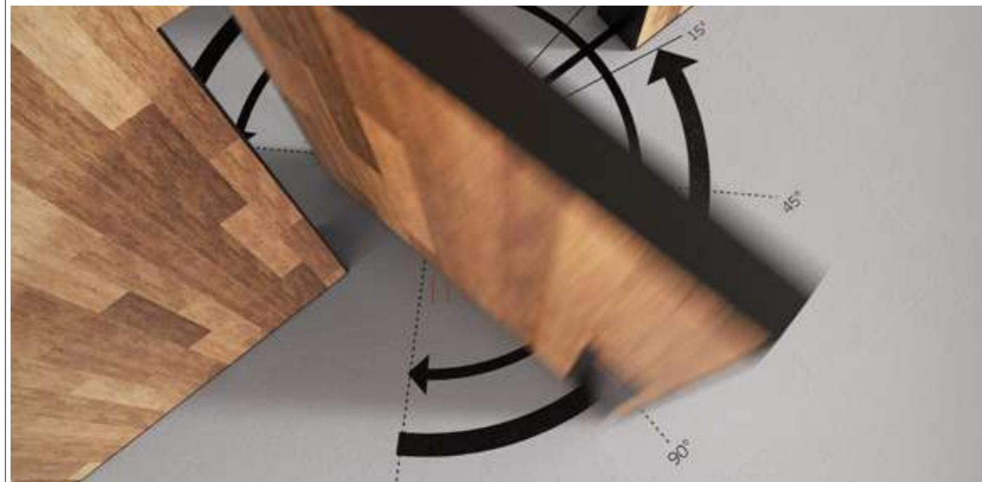
*Sistema pivotante hidráulico para portas até 1000kg. As portas podem ser de abertura simples ou de vai-vem, e com espessura desde 70mm. O sistema fica oculto no interior da porta, apenas com uma pequena base no pavimento, com regulação bidireccional e um ponto de rotação no teto ou aro superior da porta com rolamento incorporado. /*
